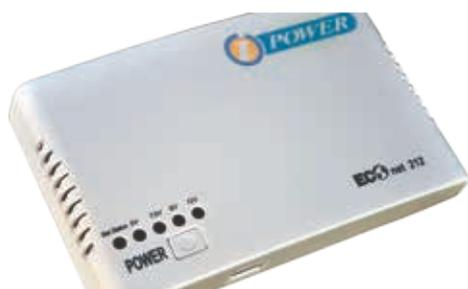
Toute en fournissant la protection d'un onduleur pour vos appareils quotidiens, l'econet se veut aussi portable et fournit grâce à ses prises USB une batterie de secours pour vos appareil portables.
